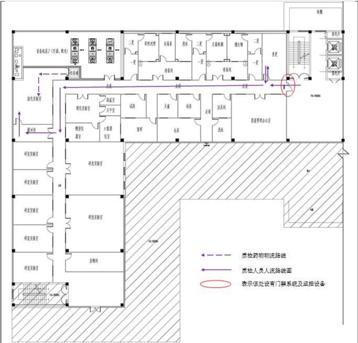
图 2-10 本项目药物生产楼二层人流及物流路径示意图
